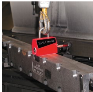
Modell 300: Gussteil an Bearbeitungszentrum
