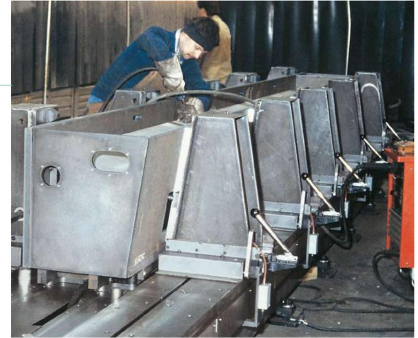
Detail: Positionierung über mechanische Anschläge. Die Spannung erfolgt mit Elektro-Haftstäben SAV 241.32, Typ D.
