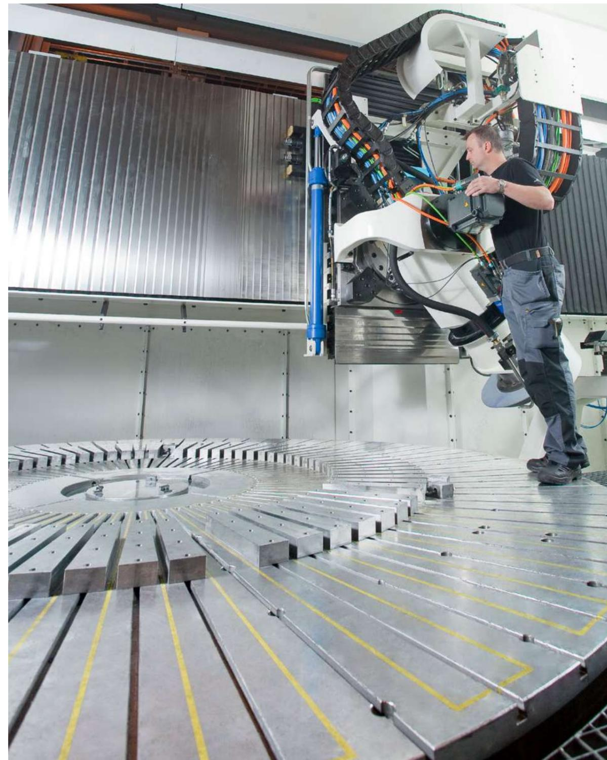
Wir fertigen Großmagnete zur Wälzlagerbearbeitung für Schleif- und Hartdrehbearbeitung. Zum Beispiel Durchmesser 4,3 m aus 2 Segmenten. Flachsleifringkörper im Zentrum integriert.
